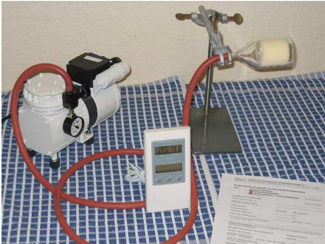
Abb. 1: Probenahme mit PUF-Sammler (z.B. Holzschutzmittel, Geruchsstoffe)
